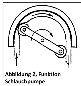
Abbildung 2, Funktion Schlauchpumpe
