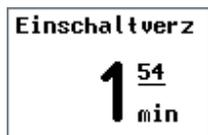
Nach dem Einschalten des Gerätes am seitlichen Hauptschalter startet die eingestellte Einschaltverzögerung und läuft bis „0“ herunter.
