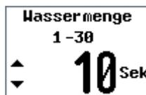
Dauer des Wasseraufgusses auf den Saunaofen einstellen (Öffnungszeit Magnetventil)
