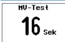
Das Magnetventil wird für die angezeigte Zeit angesteuert. Es wird Wasser auf den Saunaofen dosiert.
