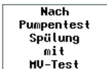
Wird versucht, den Pumpentest 2x hintereinander zu starten, so erscheint die Meldung: „**Nach Pumpentest Spülung mit MV-Test**“. Nun den MV-Test im Hauptmenü aktivieren, so dass der Duftstoff aus der Leitung ausgespült wird!
