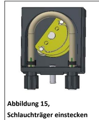
4. Drehen Sie den Rollenträger im Uhrzeigersinn und drücken dabei den Schlauch vorsichtig in das Gehäuse hinein, bis sich der Schlauch komplett im Gehäuse befindet.
