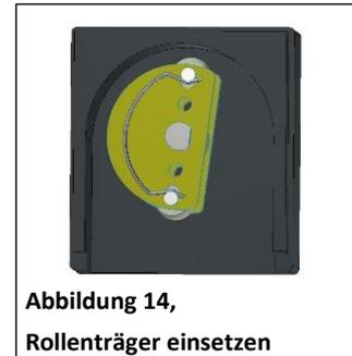
3. Stecken Sie den Schlauchträger in die Führungen des Gehäuses hinein bis er ganz einrastet.
