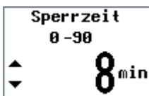
Ist die Betriebsart **Tasterbetrieb** eingestellt, so erscheint hier **Sperrzeit**. Die Sperrzeit ist die Zeitspanne während der kein neuer Aufguss gestartet werden kann. Die gewünschte Sperrzeit zwischen den Aufgüssen einstellen. Für die hier eingestellte Zeit ist kein weiterer Aufguss möglich.
