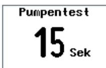
Die Duftstoff-Dosierpumpe wird für die angezeigte Zeit angesteuert. Es wird Duftstoff dosiert.
